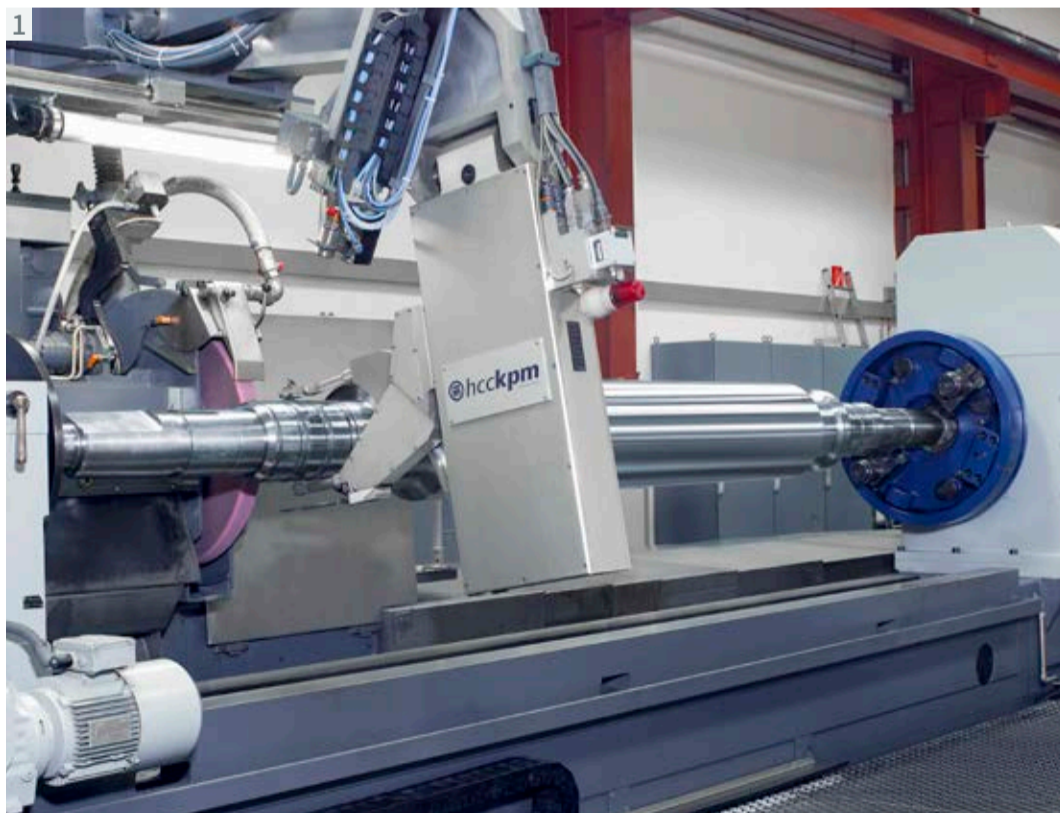
1. 借助高质量的接触点和磨削过程中的“即时”修正，获得精确的测量结果 - 这一切都得益于 C 型框架卡尺
