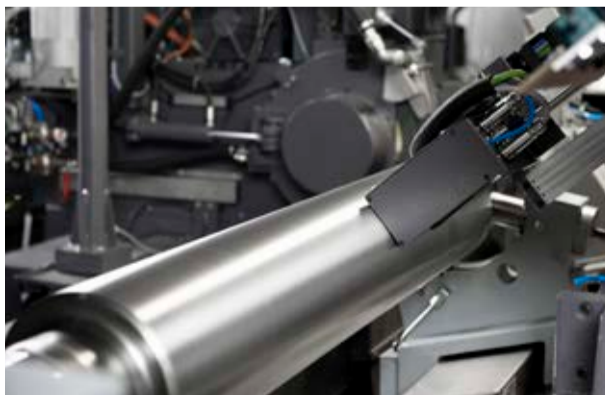
用于自动检测轧辊表面缺陷的轧辊表面检测系统 (RSIS)
